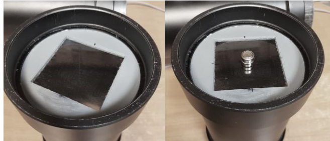
Rysunek 3. Zdjęcia gotowych ustrojów membranowych kolejno dla wariantu 1, 2
